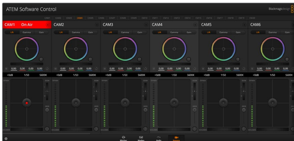
Arbeitsraum ATEM Kamerasteuerung
